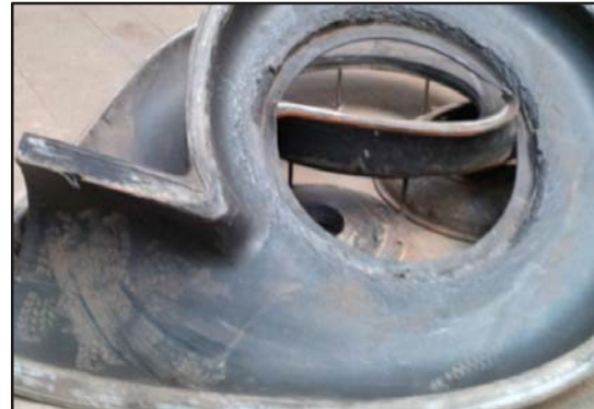
Recubrimiento dañado removido.
