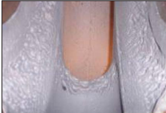
Carcaza de bomba preparada.
