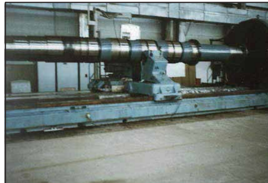
Eje de bomba multi etapa después de la aplicación de ARC 858 y ARC 855.
