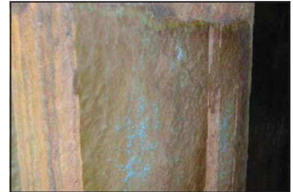
ARC S1PW después de un año de servicio.
