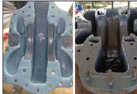
Reparación del cuerpo y la tapa.
