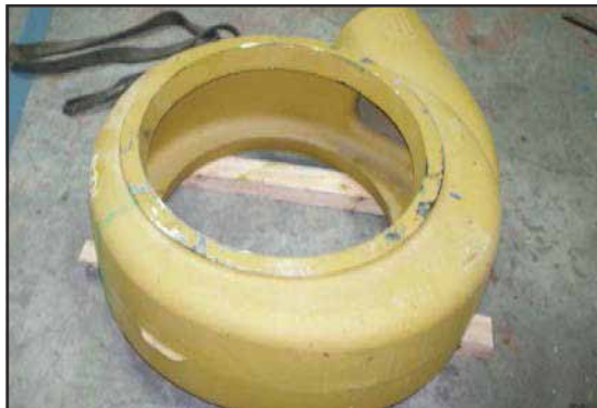
Nuevo cuerpo de la bomba antes de aplicar ARC.
