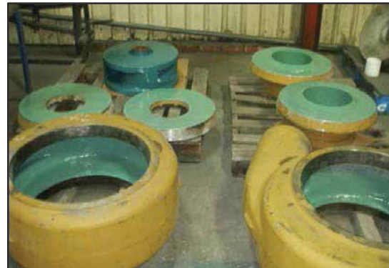
Dos bombas nuevas protegidas con ARC.
