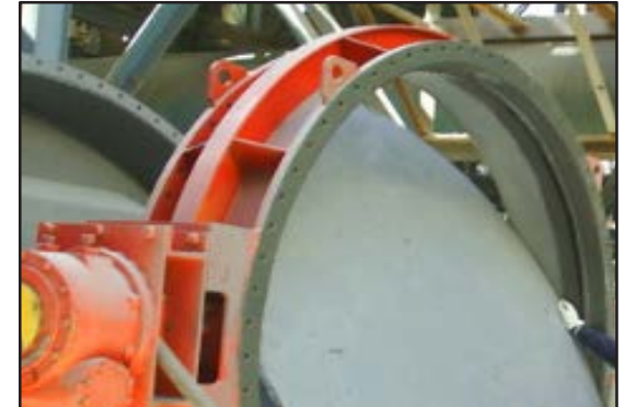
Válvula completada con capa final de ARC S4+ .
