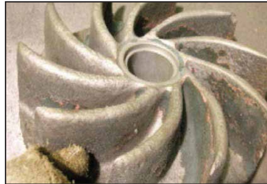
Superficie del impulsor antes de recubrir.
