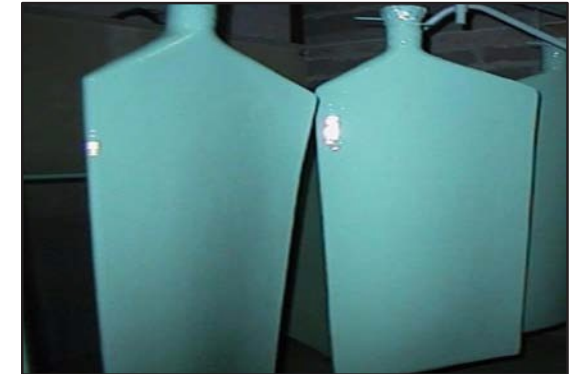
Aspas restauradas con ARC 858 y ARC S2 .
