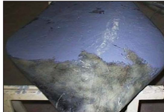
Uso de malla de fibra de vidrio como refuerzo.
