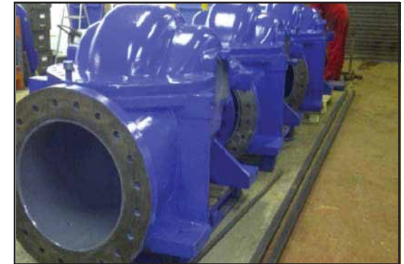
Bombas recubiertas interiormente con ARC S2 y ARC S1PW exteriormente. Capa final resistente a rayos UV.
