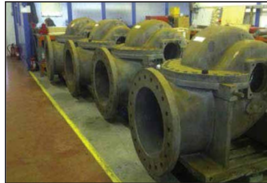
Bombas granalladas a la espera de recubrimiento.
