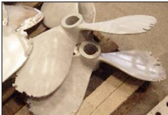
Agitadores de acero inoxidable severamente desgastados.
