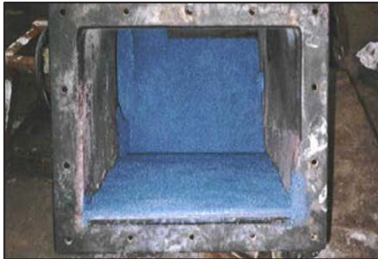
Chute de molino de bola de piedra caliza de unidad FGD con ARC MX1 aplicado a áreas de alto desgaste.
