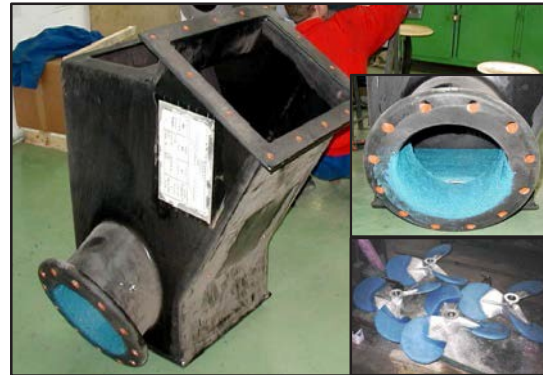
Nuevos chutes y agitadores revestidos con ARC MX1 .
