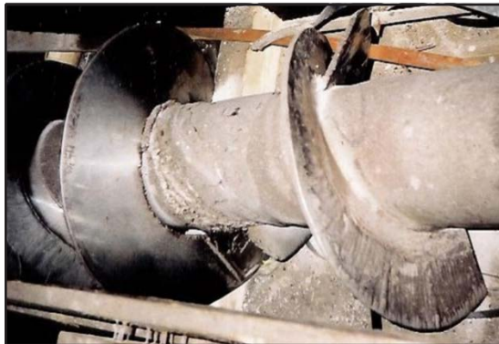
Tornillo afectado por abrasión.
