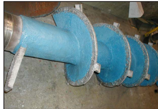
ARC MX1 y soldadura en las puntas.
