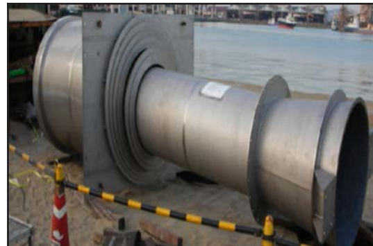
Chute telescópico de escoria granulada en el muelle de descarga en acería.
