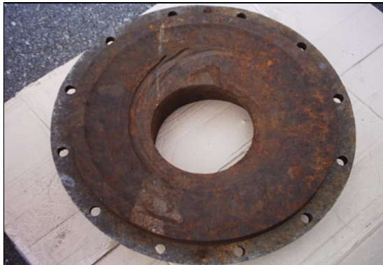
Placa desgastada de la bomba.
