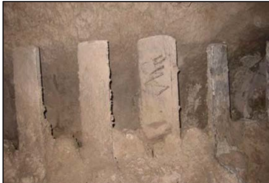
Condición de las aspas de mezclador en servicio.
