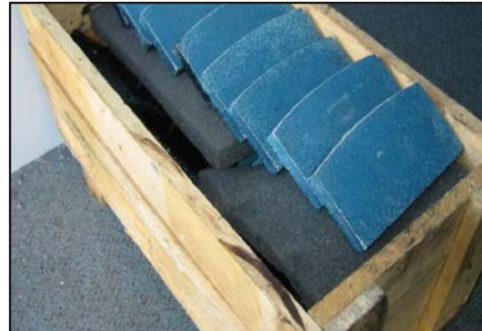
Producto resistente a la abrasión ARC moldeado en las nuevas paletas.
