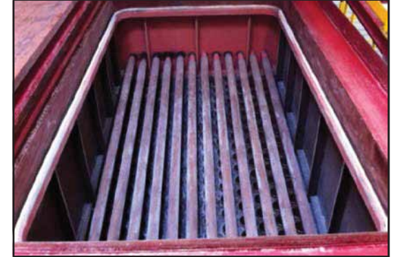
Casa de bolsa protegido con ARC S7 en servicio más de 2 años sin fallas.
