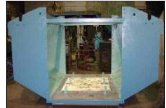
Celdas de flotación después de ARC S1PW externamente.
